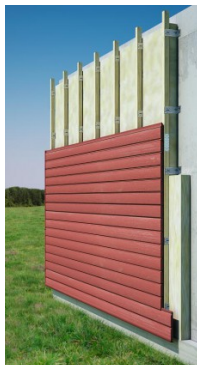
Mise en place d'un pare-pluie
