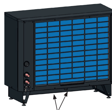
Kondensvannbeholder og kondensvannrør.
