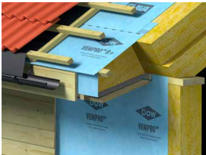
Fig. 14 Prinsipp ved utstikkende sperrer
