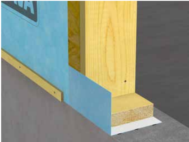
Fig. 23 Svillemembran med en leppe
