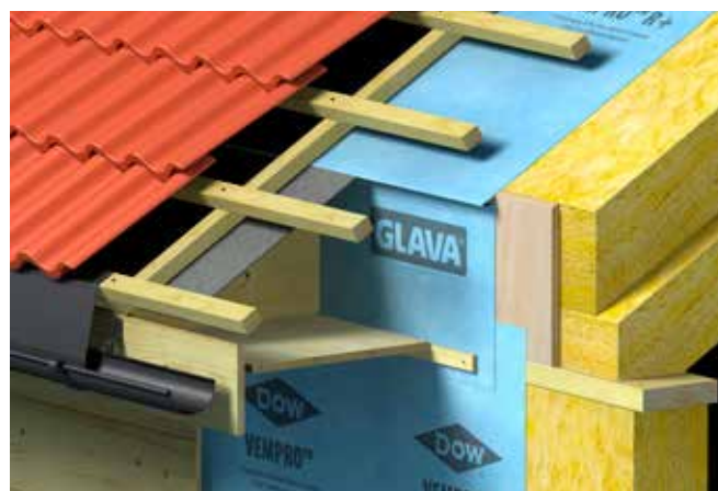
Fig. 15 Prinsipp for løse takutstikk
