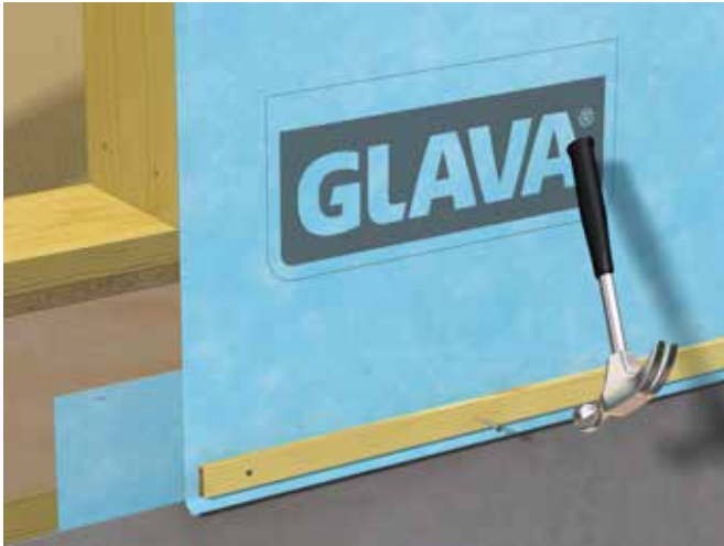
Fig. 36 Klemming av vindsperre mot grunnmursvill
