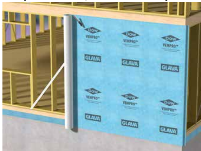
Fig. 34 Montering av etasjehøy vindsperre
