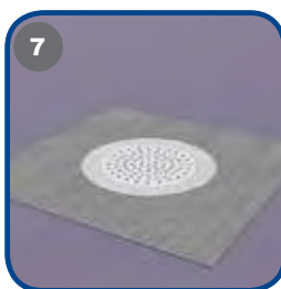
7 Monter slukringen på sluksidel og sentrer den over sluket. Trykk ned sluksilen med foten slik at den klikker på plass. Kontroller at ringen sitter riktig (bunnstilling).
