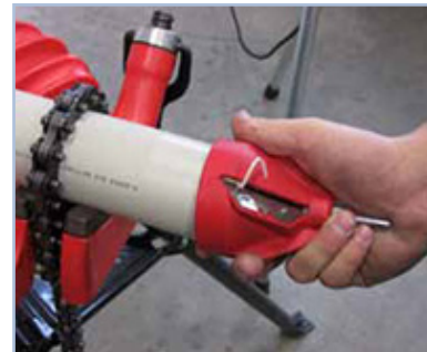
Fase enden av røret.
