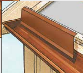
6.3.1 B Isola Takfotbeslag Powertekkplatene må festes i toppen (liten bølge) på nederste rad.
