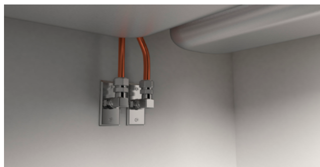
Når gjennomføring av LK PE-X og PAL Universalrør RiR uten veggboкс skal kobles til f.eks. kjøkken- eller vaskeromskraner, skal vinkelen på overgangen mellom LK PE-X - LK PAL-rør og blanderens rørforbindelse fikseres. Dette skjer forslagsvis med platealbu/ventilfeste.
